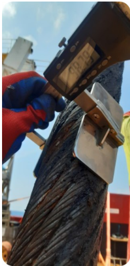
Rys. 3.2. Pomiar średnicy. Fig. 3.2. Diameter readings
