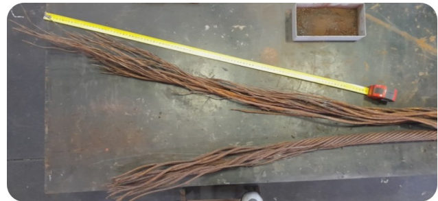
Rys. 4.3. Lina 40mm w miejscu przerwania.
