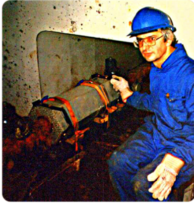
Rys. 3.5. Dr. Roman Martyna wykonujący pierwsze na świecie badanie MRT lin kotwiących platformy wiertniczej w 1985r. Fig. 3.5. World's first MRT of Anchor ropes performed by Dr Roman Martyna in 1985
