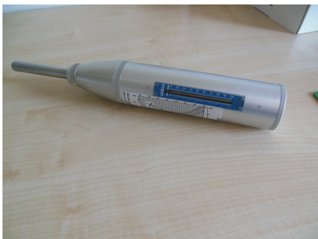
Rys. 4. Młotek Schmidta typu N będący na wyposażeniu CRB Sp. z o.o.
