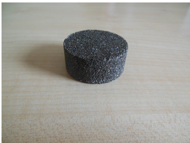
Rys. 5. Kamień będący częścią zestawu, służący do przygotowania powierzchni badanych
