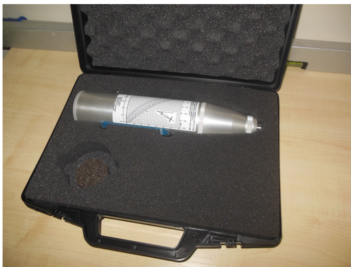
Rys. 5. Należy unikać sytuacji, w których pręt badawczy może ulec zabrudzeniu piaskiem, wodą lub innymi cieczami, mogącymi wnikać do wnętrza sklerometru
