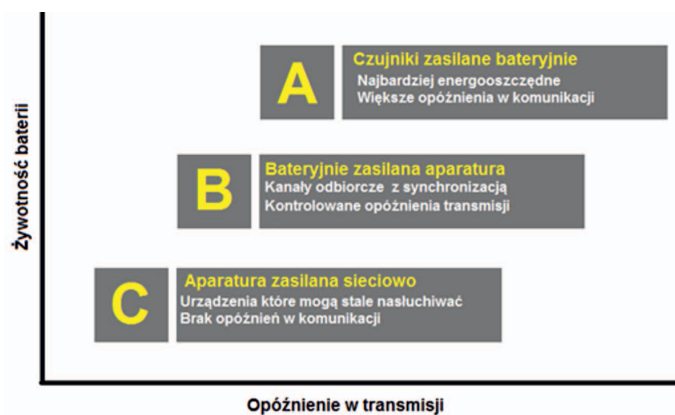
Rys. 2. Wpływ opóźnień transmisji na żywotność baterii
