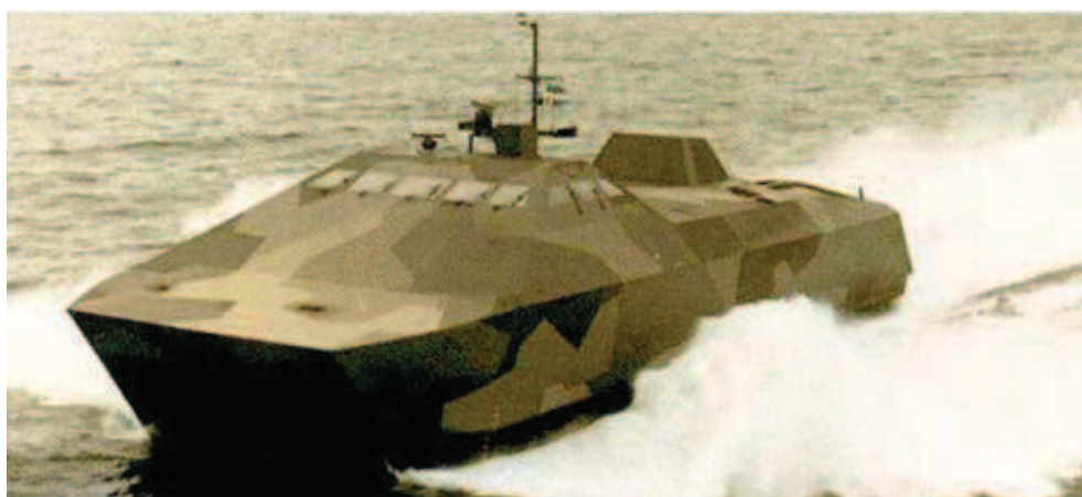
Rys. 1. Kadłub szwedzkiej korwety Smyge wykonanej w technologii laminatowej
