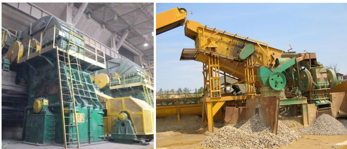
Rys. 2. Kruszarki stosowane w górnictwie rud miedzi oraz w górnictwie skalnym (źródło: www.betotrans.pl/ ) Fig. 2. Crushers using in copper ore and rock mining (source: www.betotrans.pl/ )
