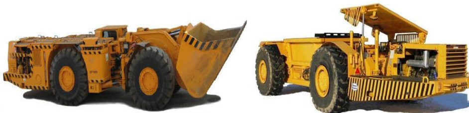
Rys. 4. Ładowarka i wóz odstawczy stosowane w oponowym transporcie cyklicznym w górnictwie rud miedzi (źródło: http://www.kghmzanam.pl/ )
