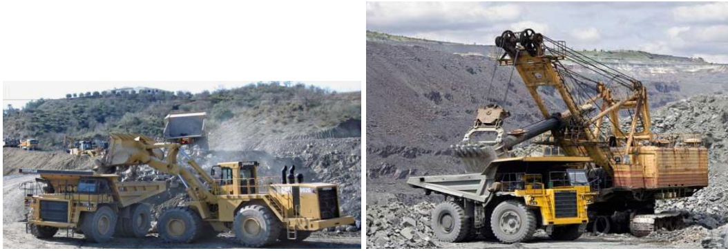
Rys. 3. Wozidła i koparki stosowane w oponowym transporcie cyklicznym w górnictwie skalnym (źródło: www.nbi.com , http://gornictwo.wnp.pl/ )
