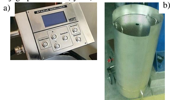
Rys. 3. Urządzenie dozująco-smarujące pozwalające na regulację wydatku środka smarno-chłodzącego: a) widok panelu sterującego, b) widok pojemnika
