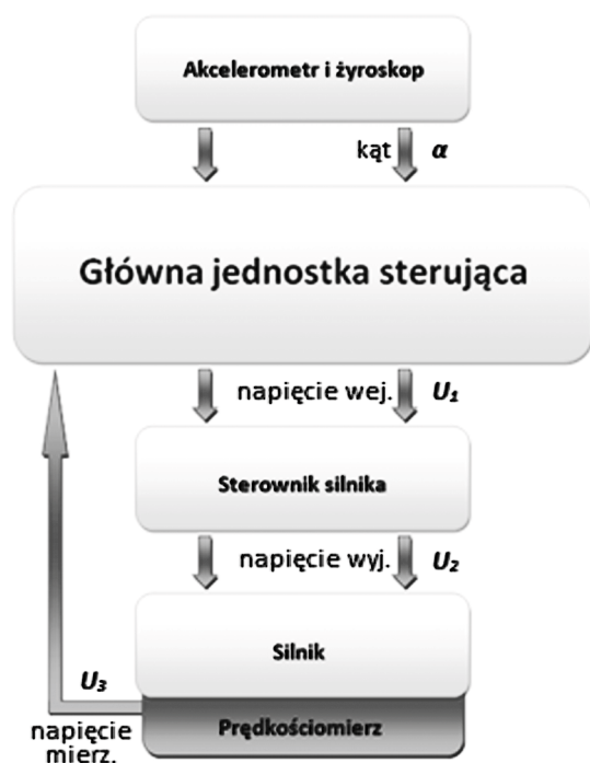
Rys. 8. Struktura elektroniczna monocyklu Fig. 8. Electronic structure of a monocykle
