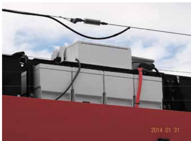
Układ UOE-60S (na górze) i bloki baterii na dachu tramwaju S70
