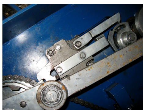
Rysunek 3. Krzywka uruchamiająca mechanizm włączający aparaty wiążące Figure 3. The cam starting the knotters actuating mechanism
