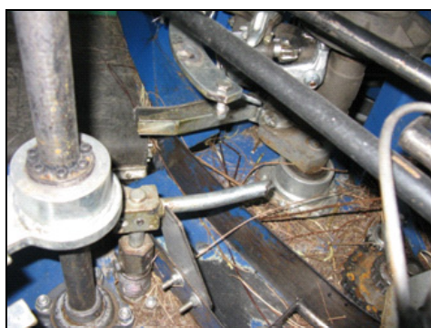
Rysunek 2. Dolny aparat wiążący i rogatka oporowa maszyny do zbioru wikliny plecionkarskiej Figure 2. The lower binding device and the resisting toll-bar of the sheaf-binder wicker harvesting machine
