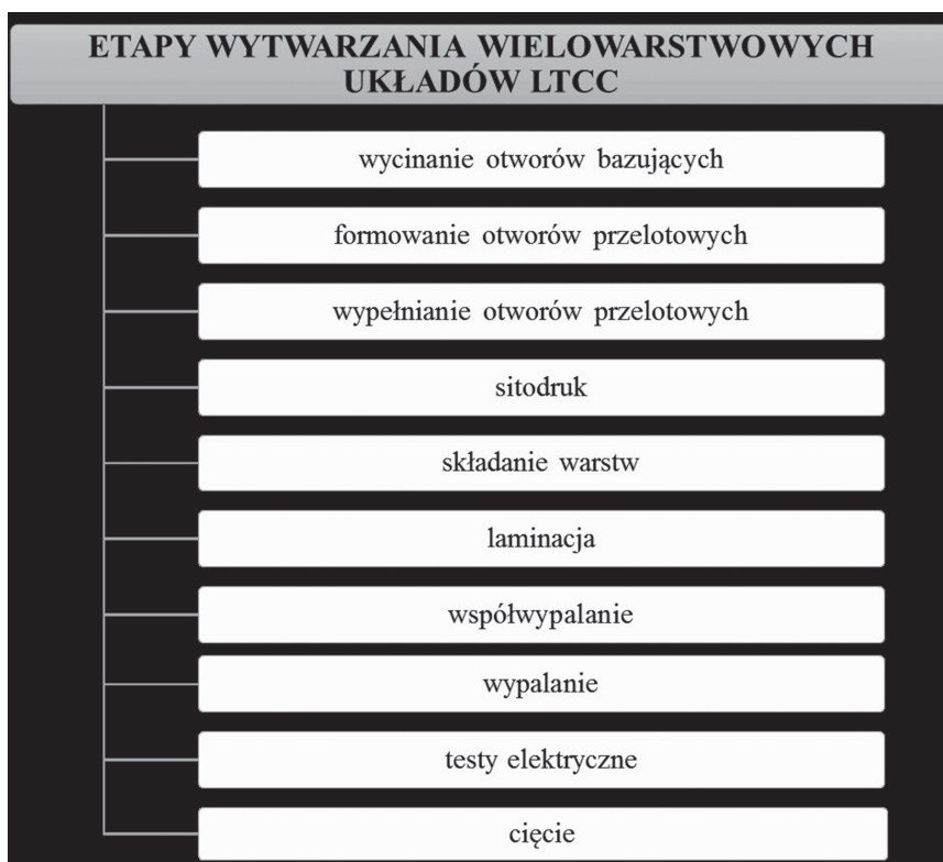
Rys. 1. Etapy wytworzenia typowych wielowarstwowych układów LTCC [5]
