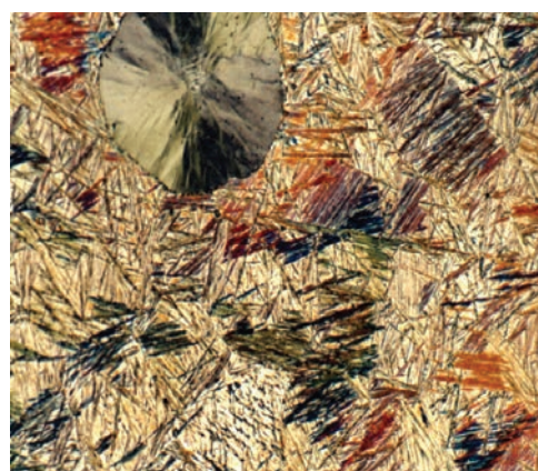
Rys. 26. Żeliwo ADI w gatunku 1400-1. Ferryt płytkowy, austenit, grafit kulkowy. Pow. 1000x
