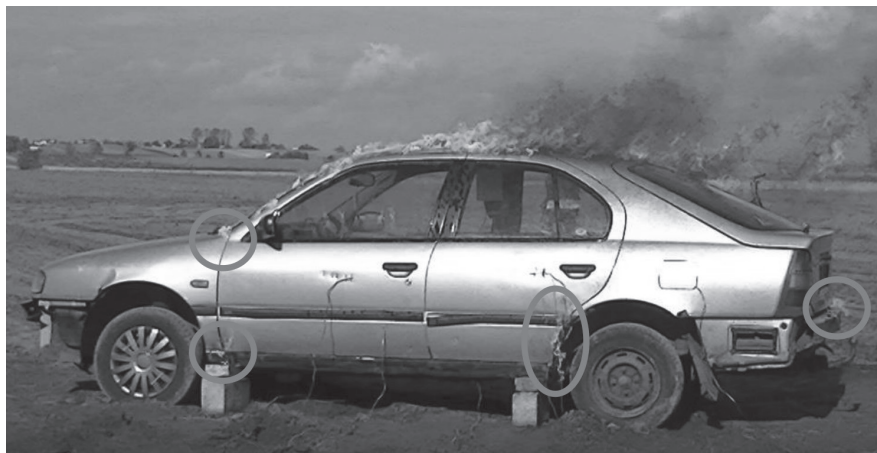
Rys. 3. Rozwój pożaru po 20 s od zapalenia. Zarzewia ognia zaznaczono okręgami i elipsą
