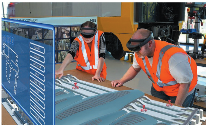
Rys. 5. Wizualizacja projektu londyńskiego dworca kolejowego Old Oak Common za pomocą AR – Rozszerzonej Rzeczywistości ( www.railway-technology.com )
