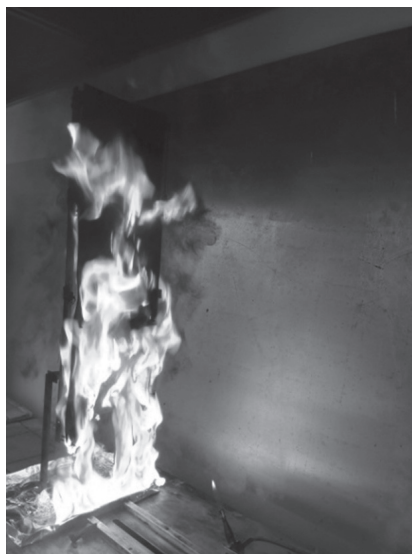
Rys. 6. Próbkę ABS 2 podczas badań, po przepaleniu trzeciej nici znacznikowej Źródło: fot. Renata Dobrzyńska
