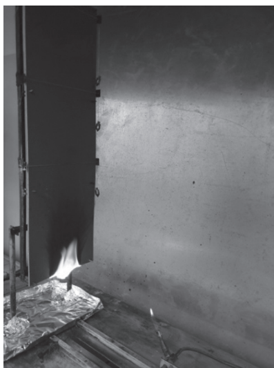
Rys. 5. Próbką ABS 2 podczas badań po odsunięciu płomienia
