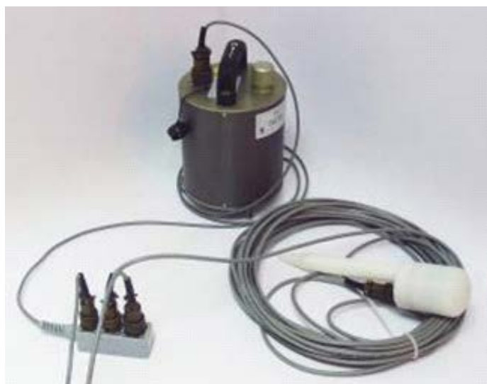
Rys. 2. Sejsmometr CMG-6TD firmy Güralp Systems Ltd. ( http://www.guralp.com/ )
