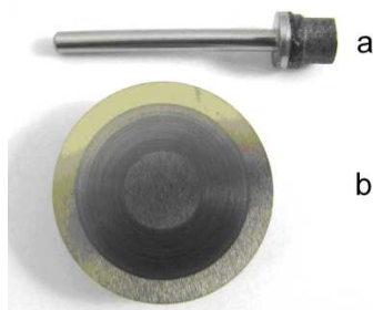
Rys. 5. a – próbka (trzcpiel); b – przeciwpróbka (krążek)
