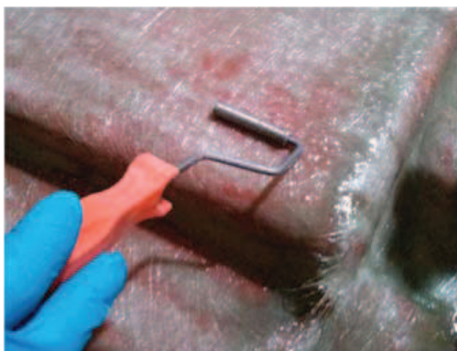
Rys. 1. Laminowanie ręczne elementów kompozytowych.
