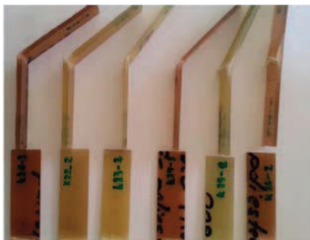
Rys.11. Odkształcenie pozostałe w próbkach po wykonanych próbach zginania Fig. 11. The deformation remaining in the samples after the bending tests carried out
