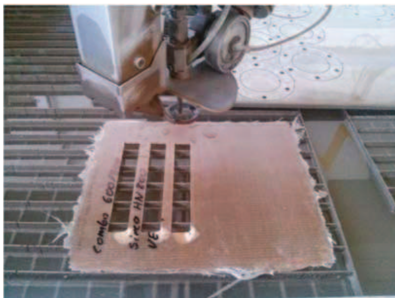
Rys. 2. Wycinanie próbek metodą water-jet.
