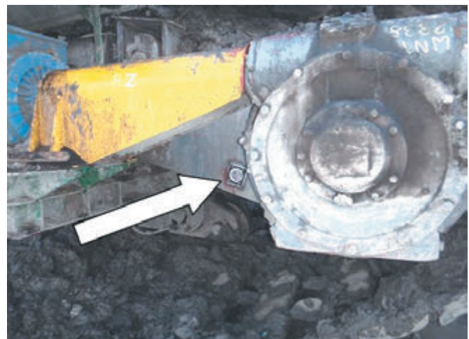
Rys. 4. Przykładowy punkt pomiarowy na belce momentowej przekładni przed podłączeniem i zabezpieczeniem
