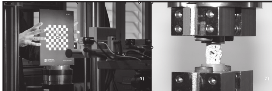
RYS.1. Stanowisko do badań biomechanicznych: a) kalibracja systemu wizyjnego na maszynie MTS; b) stabilizator międzytrzonowy podczas obciążeń cyklicznych FIG.1. Working station for biomechanical tests: a) calibration of vision system on the strength machine MTS; b) intervertebral body stabilizer during cyclic loads
