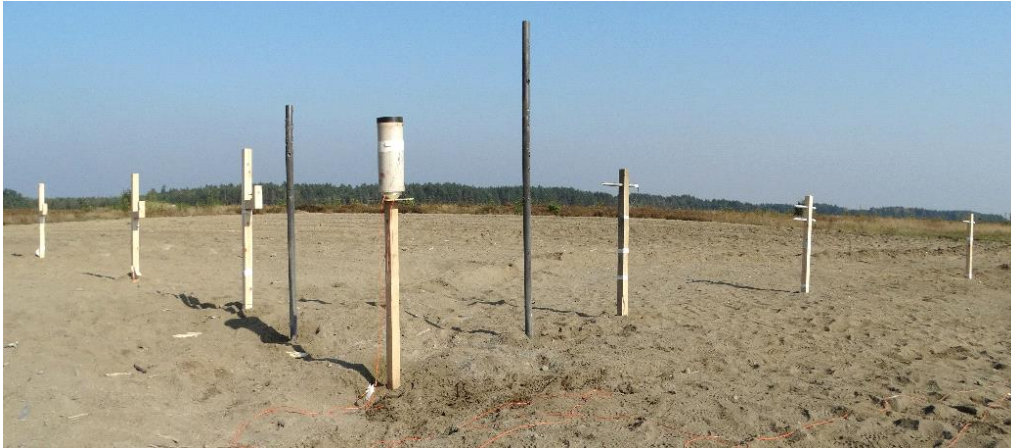
Rys. 15. Widok poligonowego stanowiska w drugiej serii pomiarów: z lewej strony głowicy - gałąź czujników PWS do pomiaru prędkości FU; z prawej - gałąź czujników p(t)M do pomiaru ciśnienia; przed obu gałęziami osłony rurowe PT osłaniające przed odłamkami
