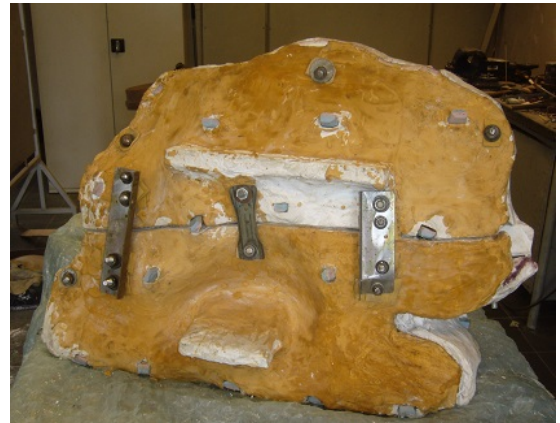
Rys. 7. System mocujący oraz zapewniający wystarczającą sztywność zestawu podczas zalewania matrycy silikonowej
