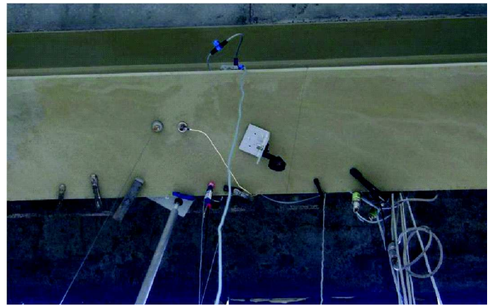
Fot. 2. Jeden z badanych dźwigarów w środku rozpiętości; widoczne przewody łączące zamocowane na górnej powierzchni dolnej półki przetworniki przyspieszeń z systemami rejestrującymi oraz różne systemy mocowania do konstrukcji drutu i sztywnej rurki do pomiaru przemieszczeń pionowych oraz przyrządy do tachimetrii (wyłącznie do badań pod obciążeniem statycznym)
