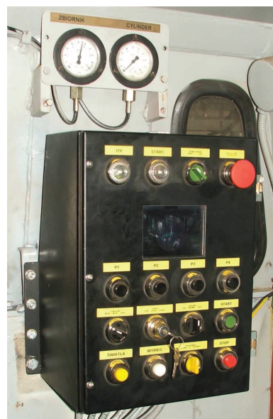
Rys.7. Nowoczesny pulpit sterowniczy MPS-1 zabudowany w kabinie lokomotywy [7]
