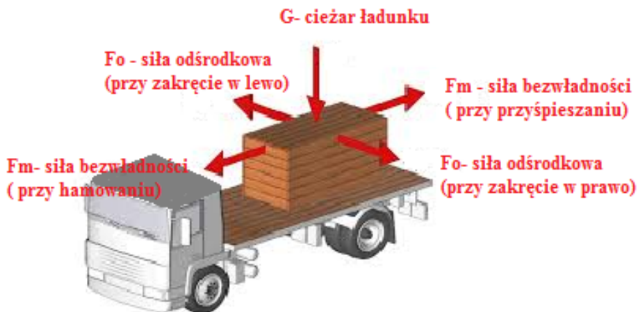
Rys. 3. Siły działające na ładunek w czasie transportu.
