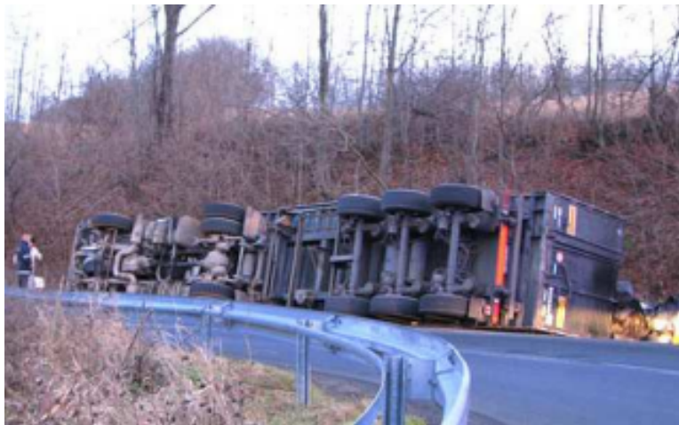
Rys. 1. Wypadek spowodowany przeciążeniem samochodu ciężarowego przy skądzie. Fig. 1. Accident caused by an overloaded lorry in a turn.
