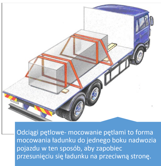
Rys. 7. Zastosowanie odciągów pętlowych.[16]
