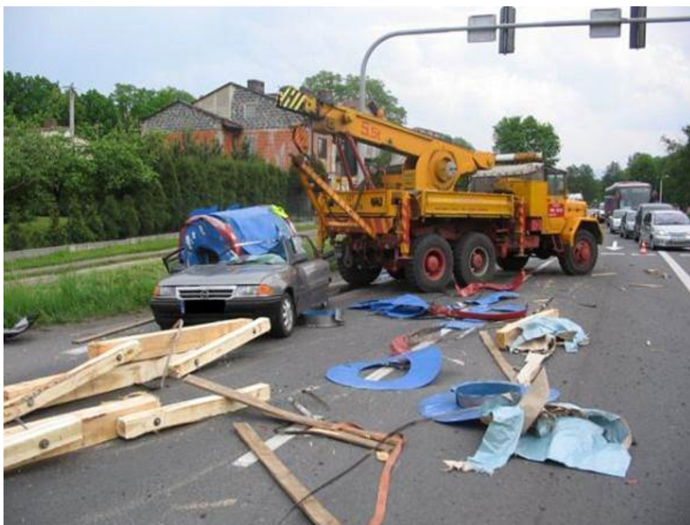
Rys. 10. Skutek nieprawidłowego zabezpieczenia ładunku [18]
