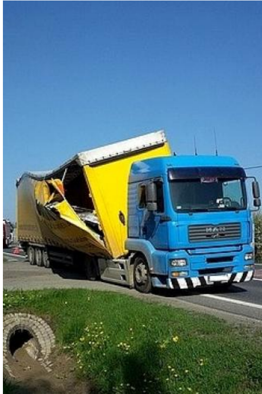
Rys. 11. Nieprawidłowe rozmieszczenie ładunku na naczepie pojazdu [19] Fig. 11. Incorrect load distribution on the vehicle trailer [19]
