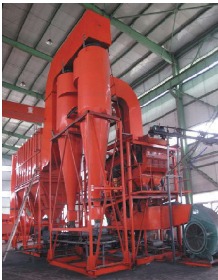
Rys. 3. Osadzarka powietrzna TFX (Shangjin i in. 2016, Materiały promocyjne firmy Tangshan)
