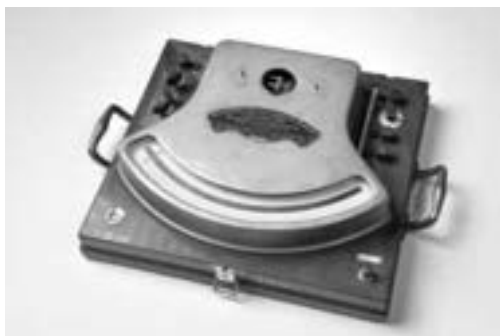
Rys. 1. Voltmierz Weston Direct Reading, Weston Electrical Instrument Co, ok. 1910 r. (zb. Sekcji Historycznej)
