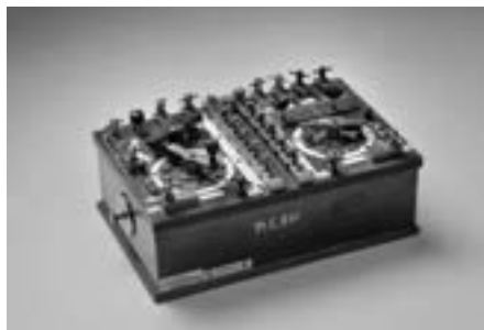
Rys. 2. Kompensator napięciowy z mostkiem Wheatstone'a, firmy Hartmann & Braun, ok. 1905-1910 r. (zb. Sekcji Historycznej)
