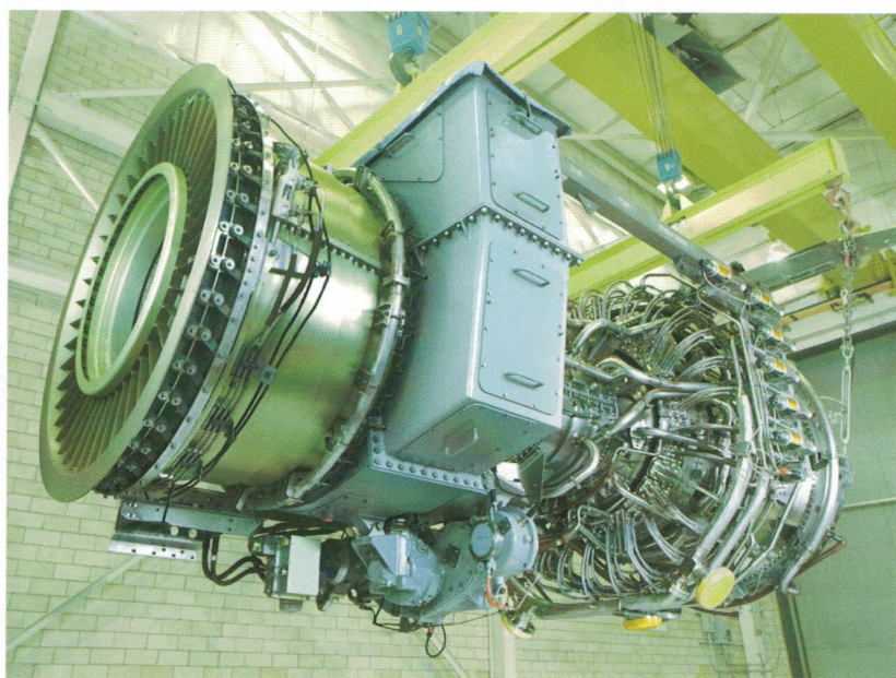
Fot. 2. Turbina LM6000
