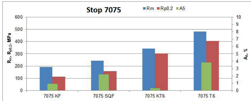
Rys. 4. Właściwości mechaniczne badanych stopów odlewanych grawitacyjnie (K) i pod ciśnieniem 150 MPa (SQ) w stanie lanym (F) i po obróbce cieplnej do stanu T6: a) stop 2024, b) 6061, c) 7075
