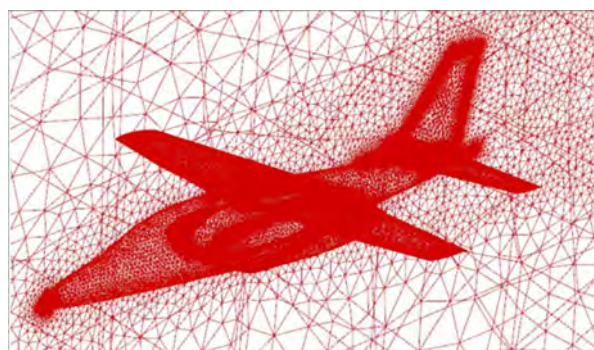
Rys. 12. Niestrukturalna siatka przepływowa dla modelu flatterowego samolotu I-22 Iryda
