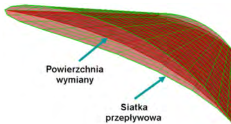
Rys. 5. Przykład powierzchni wymiany dla profilu skrzydła NACA 0012 [11]
