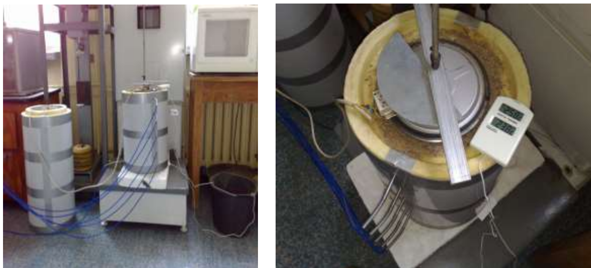
Rys.1 Stanowisko do badania próbki osypki, a) widok ogólny, b) szczegół sposobu nagrzewania gruntu płytą grzejną elektryczną.
