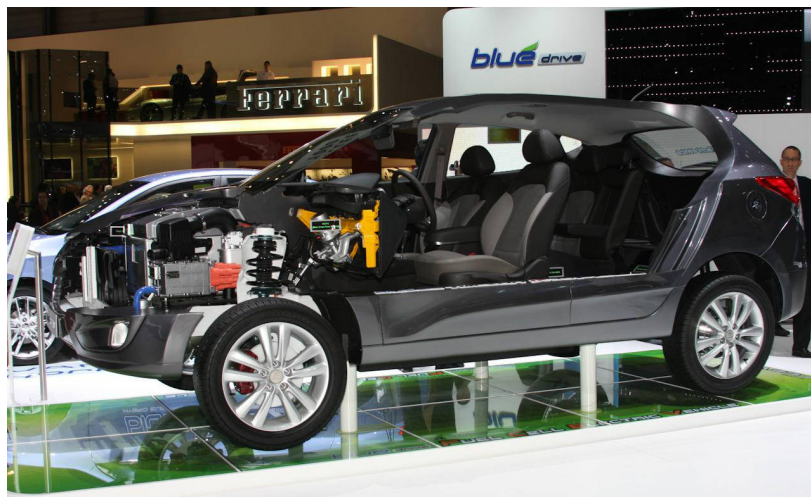
Rys. 18. Przekrój samochodu Hyundai ix35 Fuel Cell [28] Fig. 18. Hyundai ix35 Fuel Cell section [28]
