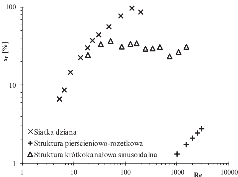
Rys. 5. Zależność udziału oporów lepkich x_f od liczby Reynoldsa Re dla badanych struktur
