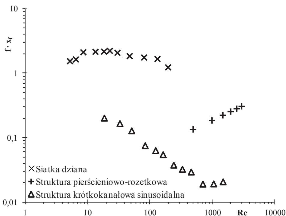
Rys. 6. Składowa lepka oporów przepływu ( f \cdot x_f ) w funkcji Re dla badanych struktur Fig. 6. Viscous friction component ( f \cdot x_f ) vs. Re for tested structures
