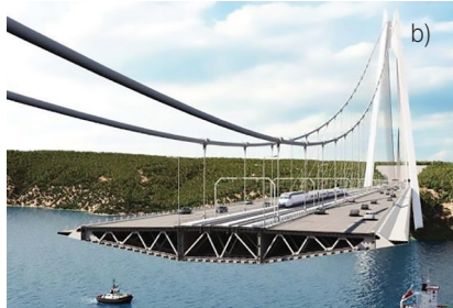
Rys. 18. Trzeci Most Bosforski, I_{max} = 1408 m, 2016 rok: a) widok ogólny [3]; b) przekrój poprzeczny przęsła – wizualizacja ( https://pl.wikipedia.org/wiki/Most_Yavuz_Sultan_Selim )
