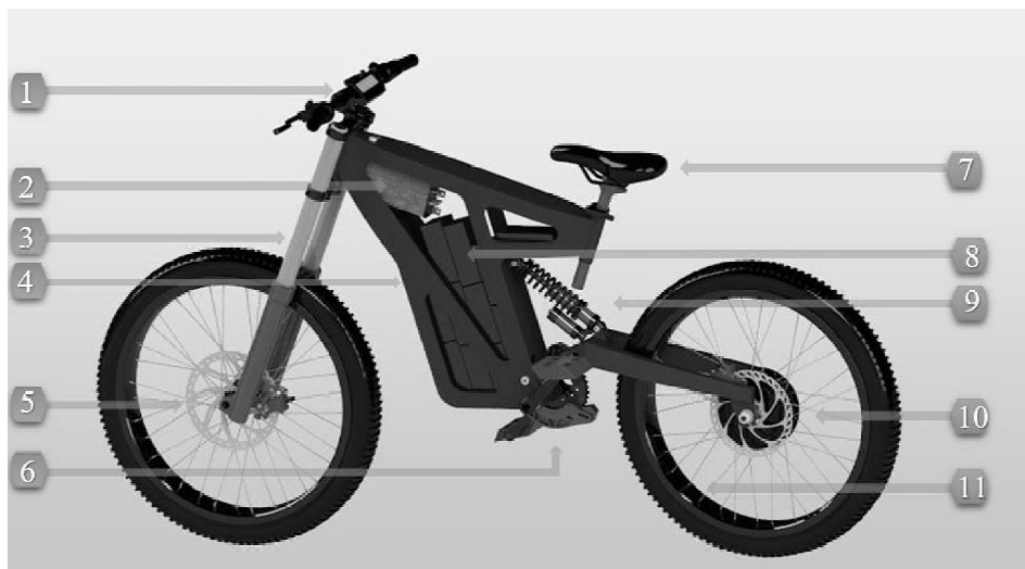
Rys. 1. Rower elektryczny z przedstawieniem poszczególnych elementów [3]: 1 – kierownica wraz z wyświetlaczem, 2 – sterownik, 3 – amortyzator przedni, 4 – rama, 5 – hamulec przedni oraz tylny, 6 – korby z pedałami i suportem, 7 – siodełko ze szyćką, 8 – akumulator, 9 – amortyzator przedni (damper), 10 – silnik, 11 – koło przednie oraz tylne z kasetą
