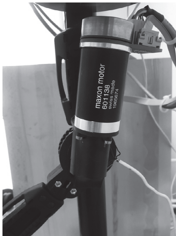
Rys. 10. Napęd BLDC MAXON EC 45 flat 50 W przegubu łokciowego
