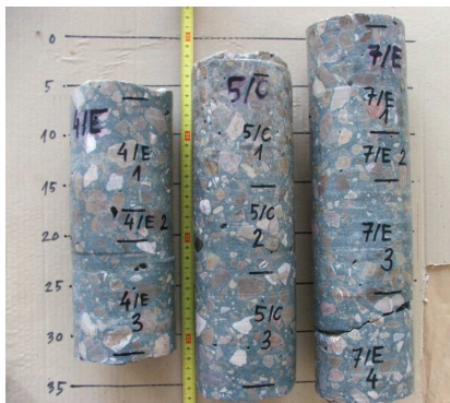
Rys. 6. Rdzenie betonowe pobrane do badań
