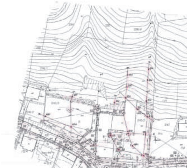
Rys. 4. Plan otworów badawczych i przekrojów geotechnicznych
