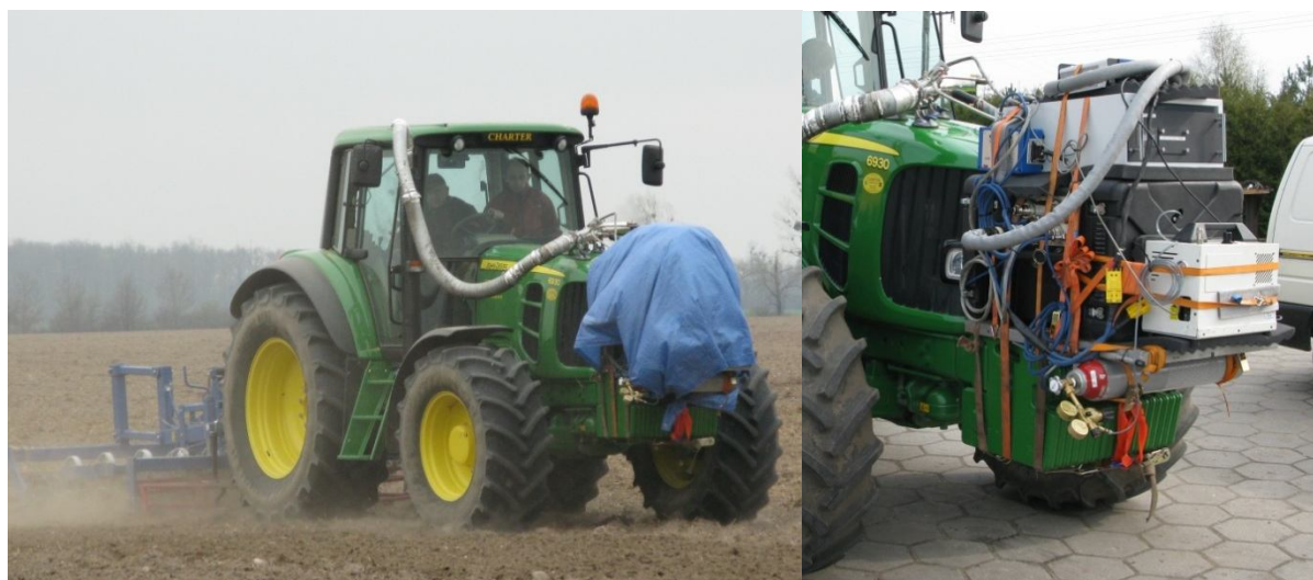
Rys. 2. Widok ciągnika wraz z zamontowaną aparaturą badawczą podczas wykonywania badań
