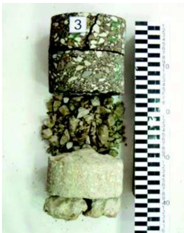
Fot. 13. Spękanie propaguje tylko w górnej warstwie AC WMS
