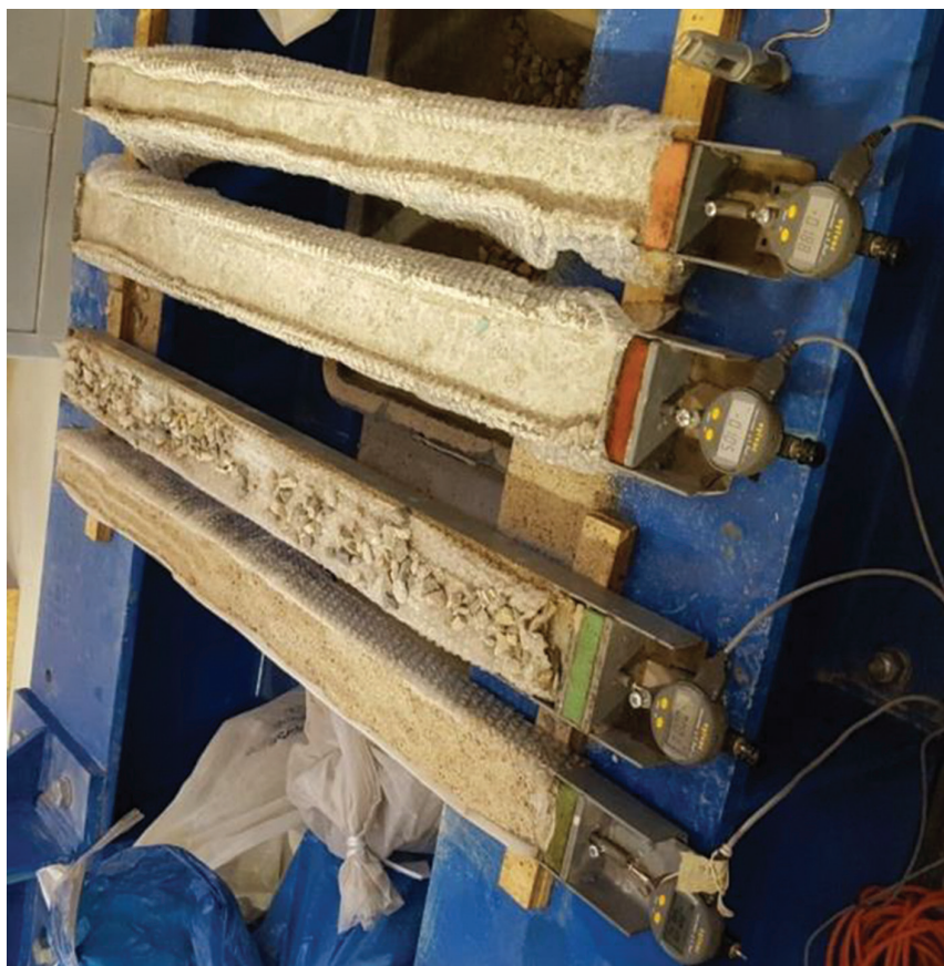
Fot. 1. Widok dwóch próbek serii A i dwóch serii BP w trakcie badań skurczu w rynnach RS800 (autor: K. Kamiński)
