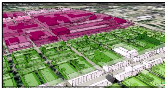
Rys. 8 Modele 3D budynków LOD2 w raz z kopertami parceli w programie CityEngine (opracowanie własne, 2016)
