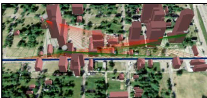
Rys. 11 Modele 3D budynków LOD2 wraz z zaznaczonymi punktami obserwacyjnymi i liniami widoczności i ‘niewidoczności’ w programie ArcScene (opracowanie własne, 2016)
