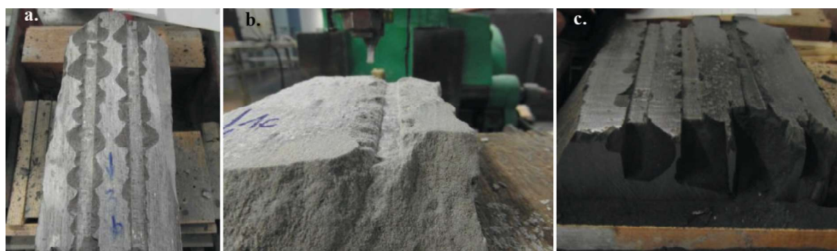
Rys. 5. Badania skrawalności rud miedzi: a. dolomit, b. piaskowiec, c. łupki
