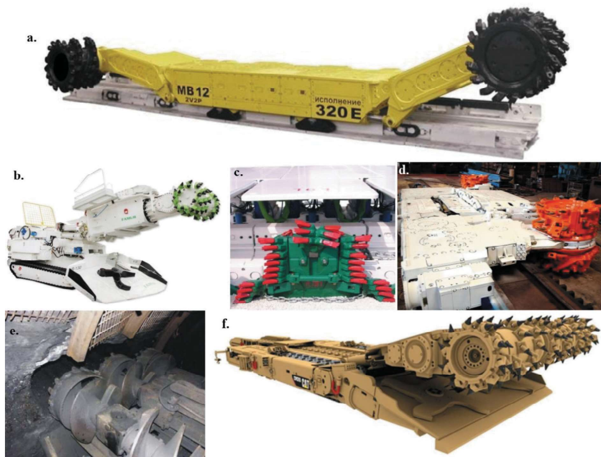
Rys. 2. Wybrane maszyny urabiające w górnictwie podziemnym: a. kombajn ścianowy (MB12 320E TMachinery a. s.), b. kombajn chodnikowy urabiający punktowo (R-130 FAMUR S. A.), c. statyczny strug węglowy (PL 738V Ostroj a. s.), d. kombajn ścianowy z pionowymi osiami (KTB200 Corum Group), e. kombajn wierzący (VS-SEAL-625 z OKD Ostrava), f. kombajn chodnikowy urabiający liniowo (CM210 CAT)
