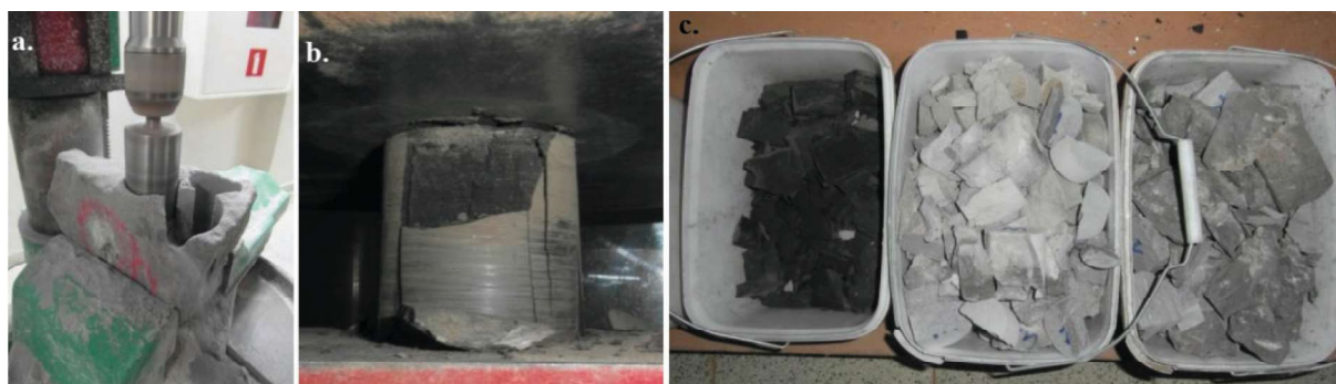
Rys. 4. Badania R_c rud miedzi: a. przygotowanie próbek, b. łupki podczas badania R_c , c. złom łupka, piaskowca i dolomitu po badaniach
