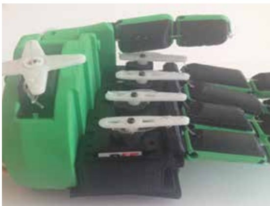
Rysunek 4. Zamocowane żyłki na orczykach
