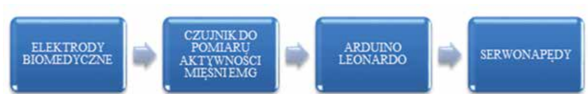
Rysunek 6. Schemat zasady działania protezy dłoni [1]
