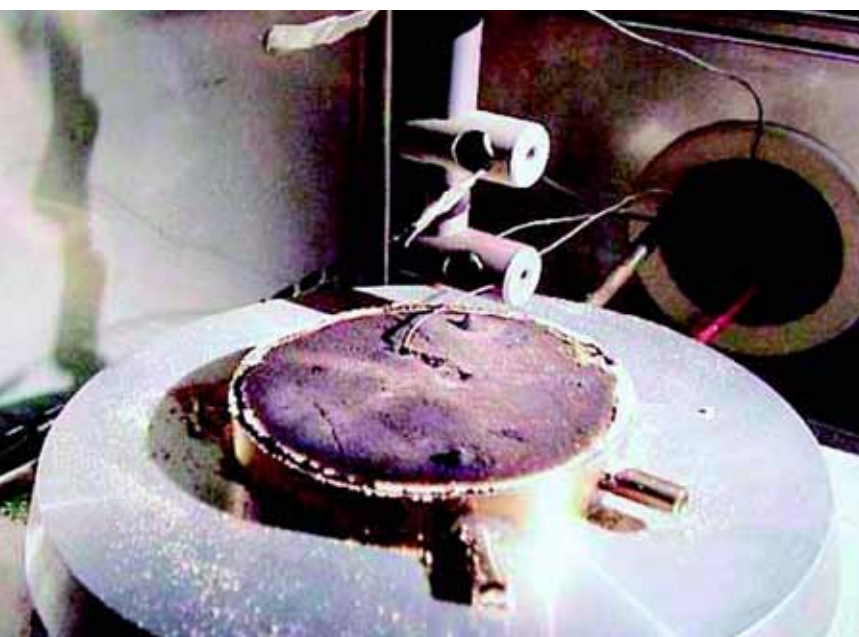
RYS. 5. Pomiar temperatury bezpłomieniowego spalania (dla warstwy 15 mm)
