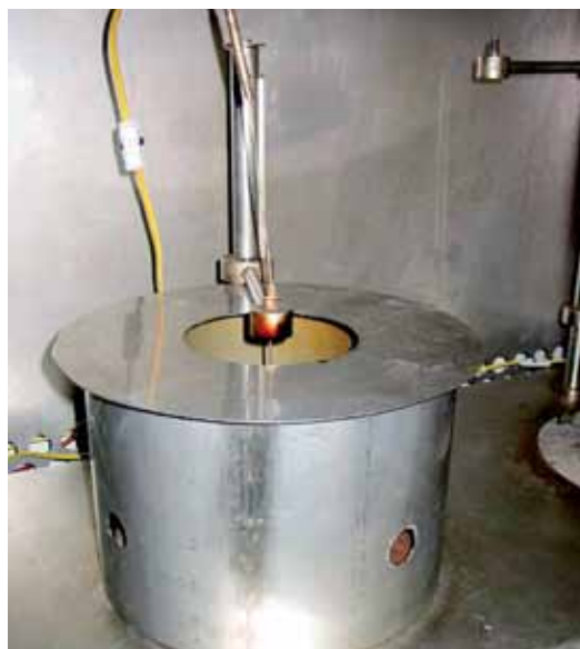
RYS. 10. Prototyp do wykonywania zmodyfikowanego testu spalania bezpłomieniowego
