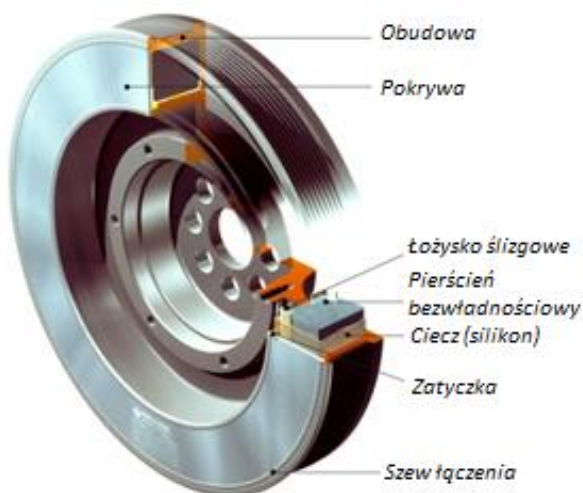
Rys. 1. Wiskotyczny tłumik drgań skrętnych [13].
