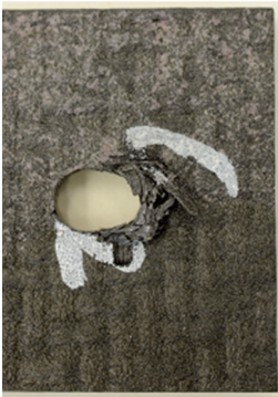
Rys. 9. Zniszczenie typu laminare bearing próbki 500-1 po badaniu wg ASTM 5961 [materiały własne]
