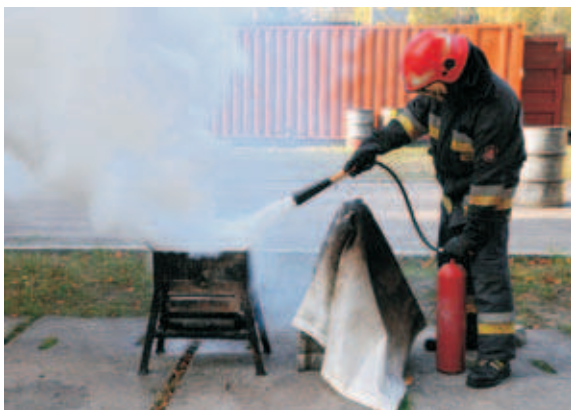
Fot. 5. Działanie dwutlenkiem węgla, po stłumieniu płomieni nastąpił nawrót spalania Źródło: fot. Bernard Król.
