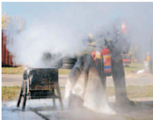
Fot. 3. Gaszenie gaśnicą pianową AFFF, bezpośrednio po rozpoczęciu podawania środka gaśniczego
