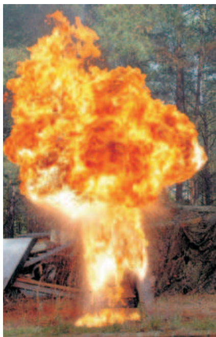
Fot. 1. Efekt wlewania wody do płonącego oleju jadalnego
