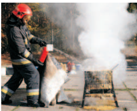
Fot. 11. Wykipienie zawartości tacy podczas gaszenia pożaru gaśnicą ABF nr 6
