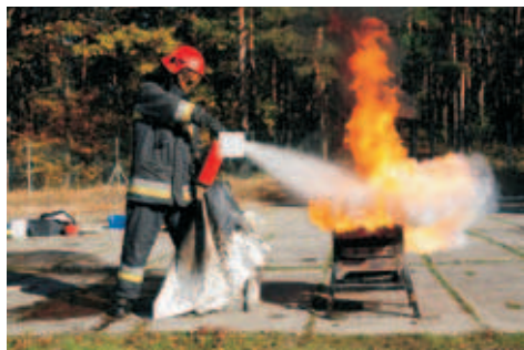
Fot. 12. Początek gaszenia gaśnicą ABF nr 7 Źródło: fot. Bernard Król.
