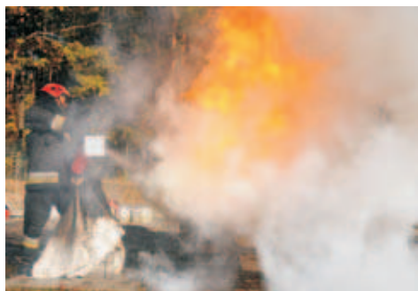
Fot. 14. Znaczny wzrost płomieni bezpośrednio po otwarciu zaworu gaśnicy nr 8 Źródło: fot. Bernard Król.
