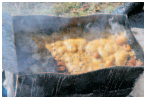
Fot. 13. Powierzchnia oleju po ugaszeniu gaśnicą nr 7 Źródło: fot. Bernard Król.
