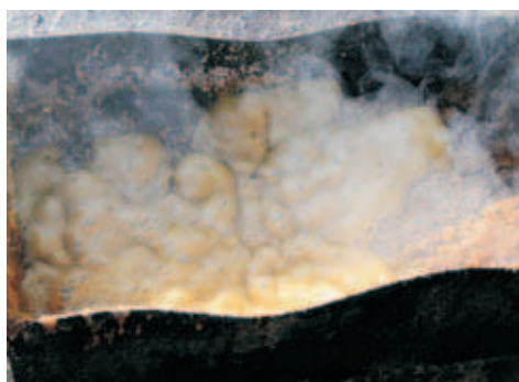
Fot. 9. Warstwa produktów reakcji zmydlenia na powierzchni oleju po ugaszeniu gaśnicą nr 4 Źródło: fot. Bernard Król.
