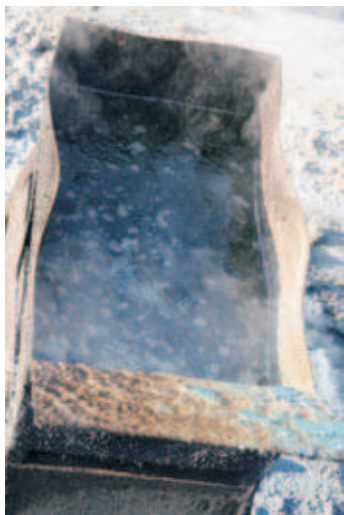
Fot. 7. Powierzchnia oleju po gaszeniu proszkiem gaśniczym Źródło: fot. Bernard Król.
