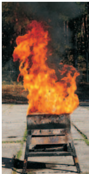
Fot. 2. Pożar testowy 15F wg ISO 7165
