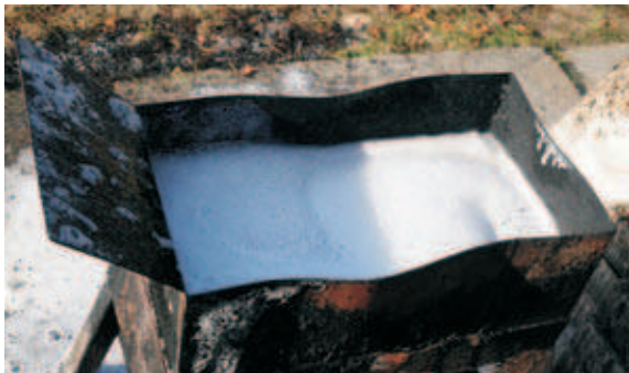
Fot. 4. Powierzchnia oleju po ugaszeniu pianą AFFF Źródło: fot. Bernard Król.
