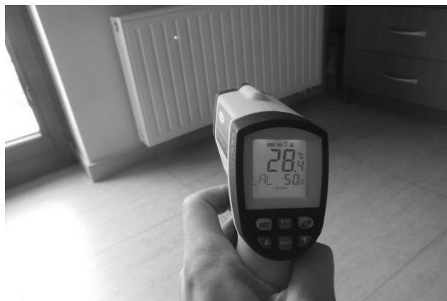
Fot. 2. Pomiar temperatury grzejnika, która wynosi 28,4°C
