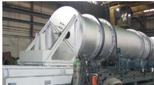
Rys. 3. Widok komory obrotowej do suszenia i pirolizy podczas wstępnego montażu w wytwórni.
