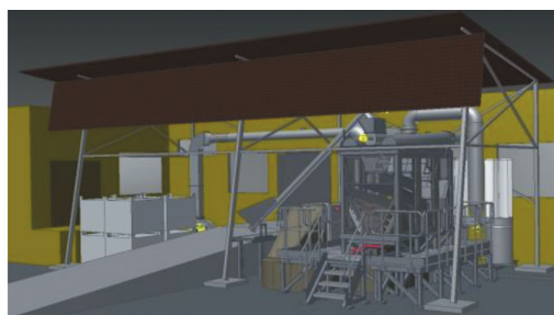
Rys. 2. Wizualizacja projektu z nagrzewnicą wodną i zdwojnym systemem odpylania [3][4] Fig. 2. Visualization of the project with water heater and extraction double-system
